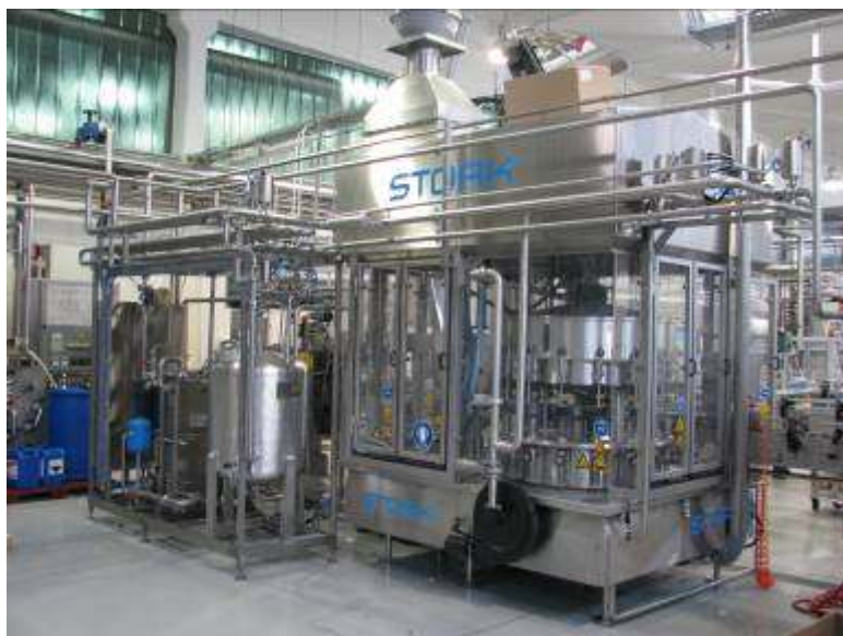
Polnilna linija Stork za polnjenje sokov in nektarjev v stekleno embalažo.
